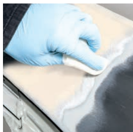
BONDERITE M-NT 1455 W termék alkalmazása csak csupasz fém felület esetében. 2 percre tartjuk nedvesen a felületet.
