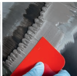
TEROSON EP 5010 TR termék szétterítése.
